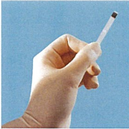
Când zona de test devine neagră soluția este eficientă
